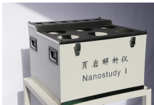
图 2. 新型页岩气解析仪 (装配完毕后实物拍摄图替换)
