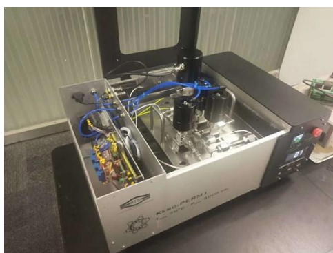
图 1. 新型储层岩石渗透率测量仪
