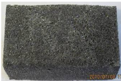
上图 废 CRT 屏玻璃资源化产品—节能环保材料-低密度泡沫玻璃产品 (5) LCD 回收处理关键设备
